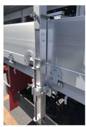
上部フックをあおりに引っ掛けて固定し、調整ナットでロックプレートを固定するだけで取付できます。
